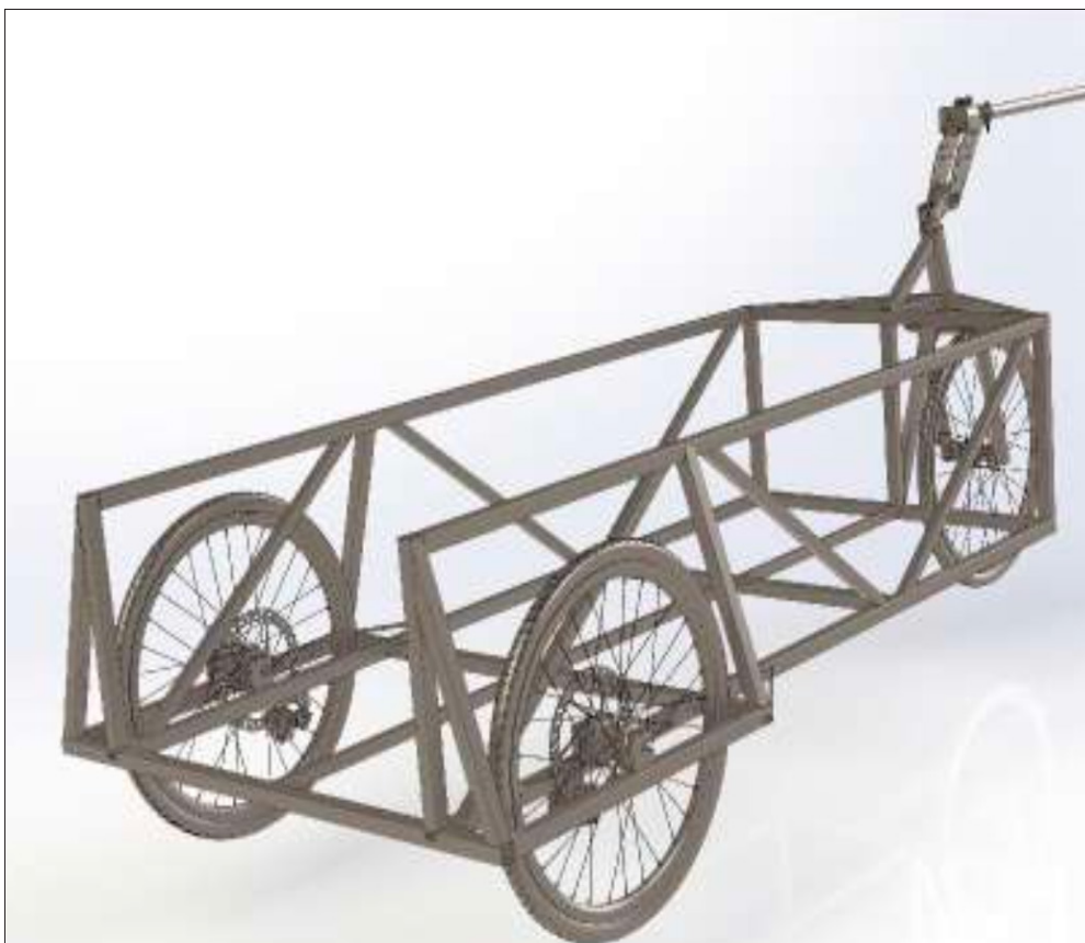
Croquis 1 : image extraite du projet Charette (remorque auto freinante à 3 roues, la remorque vélo en open source ).
